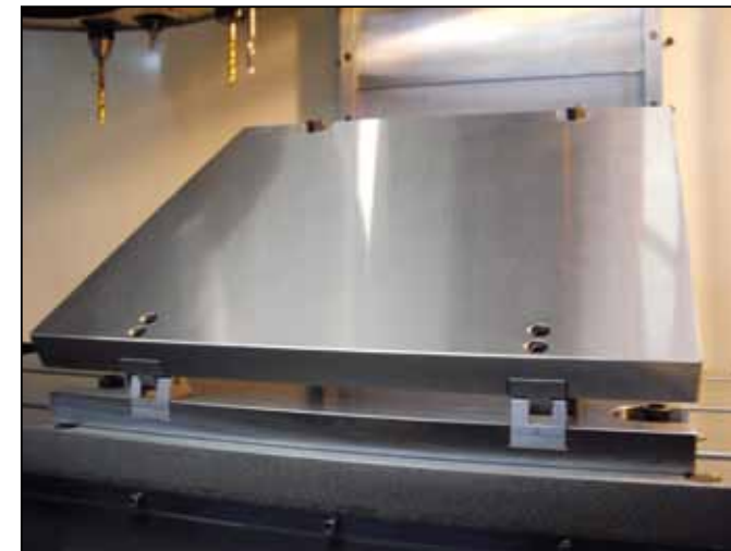
Winkelplatte kann nach Ihren Wünschen bearbeitet werden (Standard ohne Bohrungen)
