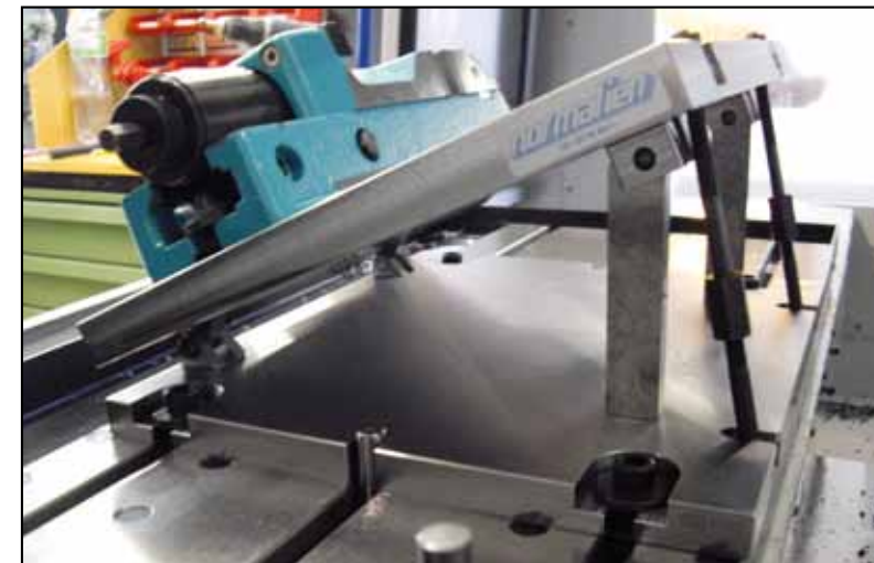
Grundplatte mit Spann- und Zentriernuten (abgestimmt zu Ihrer Maschine)
