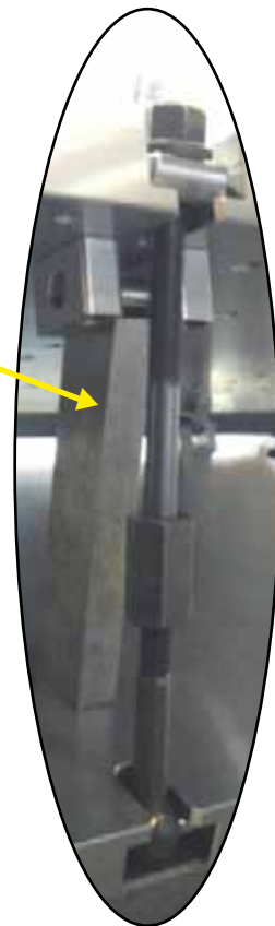
4 – fach fixierbar (vorne und hinten), was auch Schruppbearbeitungen ermöglicht
